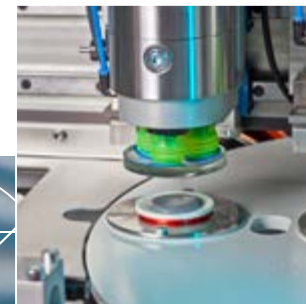
Posicionamiento de alta precisión de la lente sin necesidad de anillos de bloqueo.
