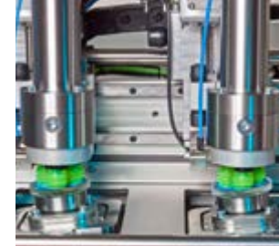
Sistema de bloqueo de doble estación para una mayor productividad.
