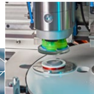
Posicionamento de alta precisão das lentes sem a necessidade de anéis de blocagem.
